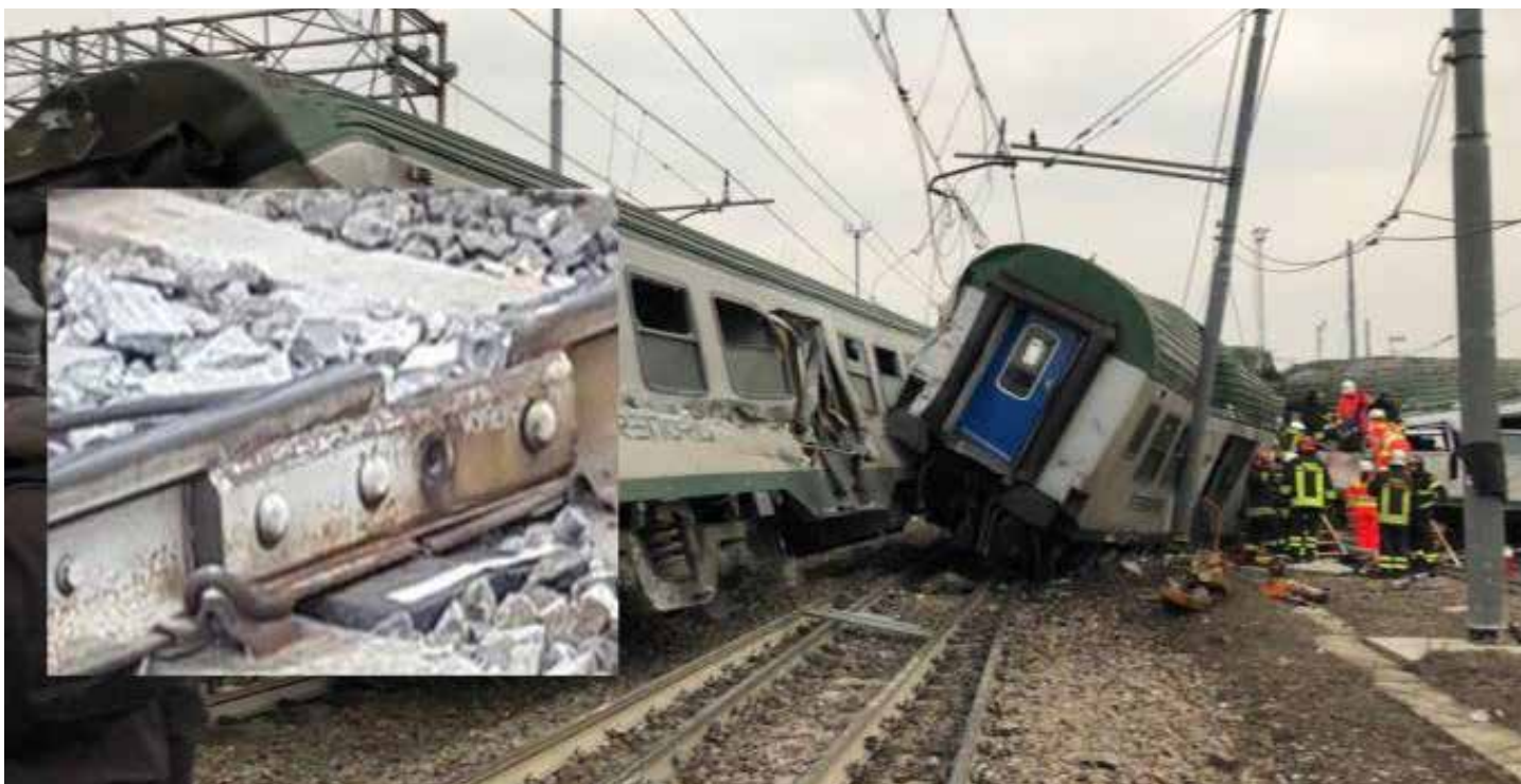
Il grave incidente ferroviario di Pioltello (Milano) dove hanno perso la vita tre lavoratrici. Nel riquadrino il particolare del binario non riparato che è stato causa del deragliamento
